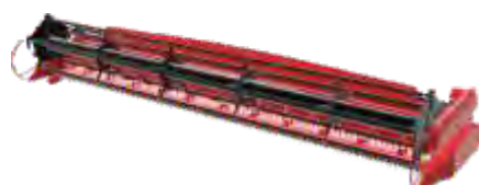
Жатка универсальная с гибким режущим аппаратом TANZER
